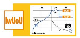
Charge automatique: La charge est sans surveillance. Une fois la charge terminée, Batium maintient le niveau de charge et peut rester connecté à la batterie du véhicule en toute sécurité.
